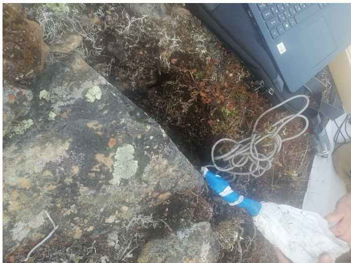
Фото 5. Процесс герметизации датчиков считывания температур.
