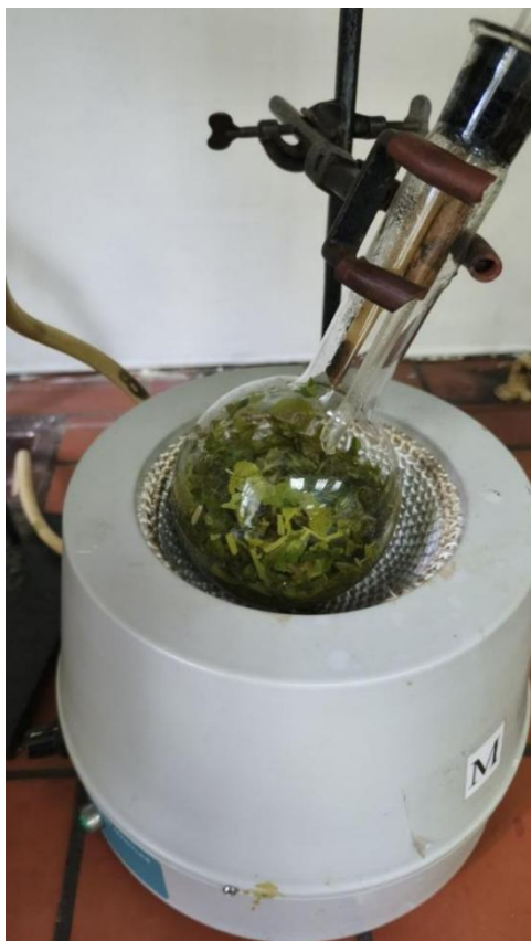
Рисунок 11 - Получение эфирных масел методом дистилляции, 1 этап
