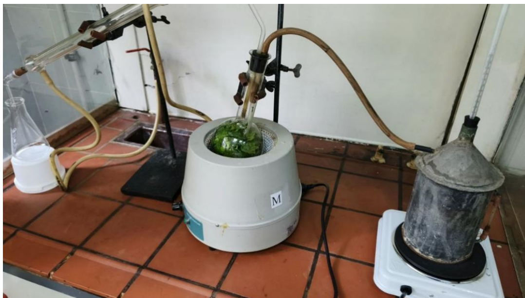
Рисунок 11 - Получение эфирных масел методом дистилляции, 1 этап
