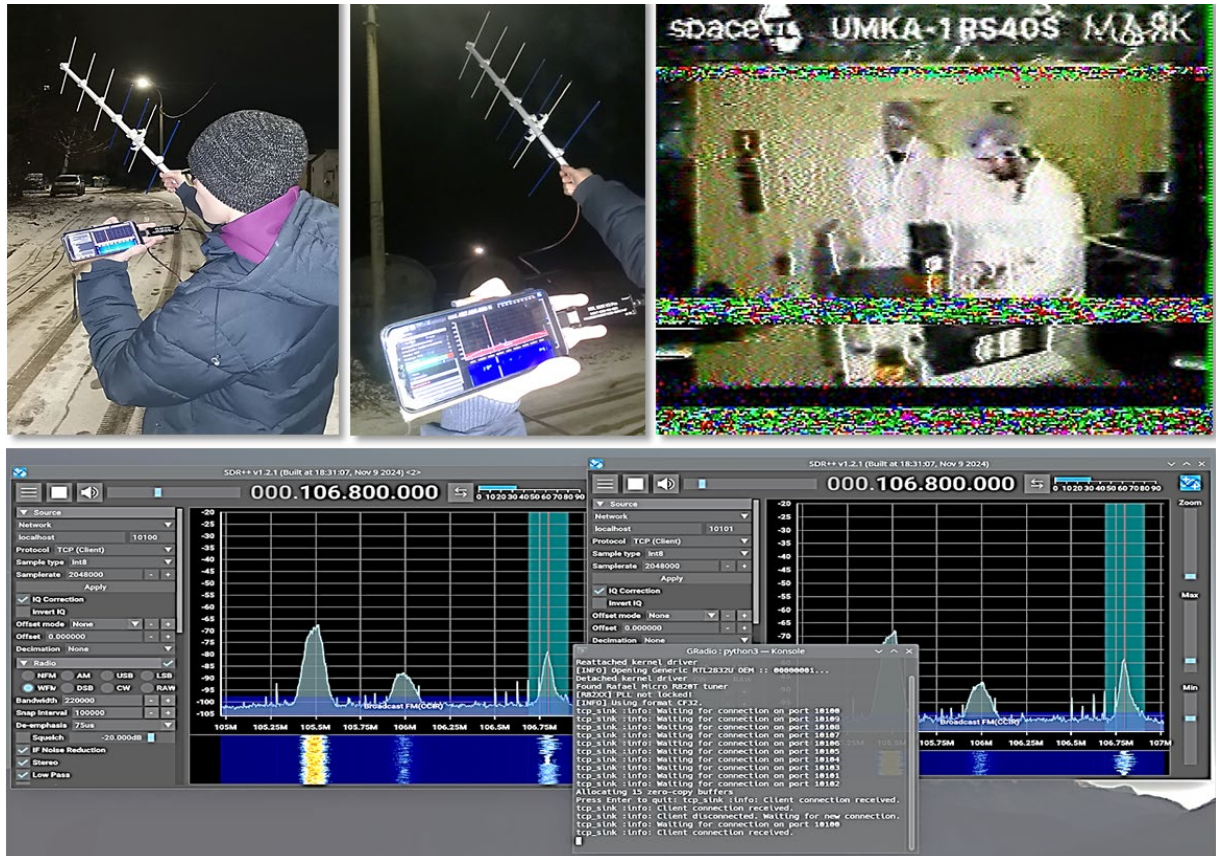
Рис. 2. Реализованный прототип спутниковой антенны и результаты приема и обработки сигнала в мобильной SDR комплексе
