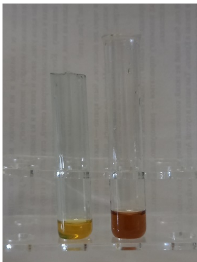
Рис. 3 Жидкость для вейпа с никотином до и после добавления пероксида водорода и концентрированной серной кислоты
