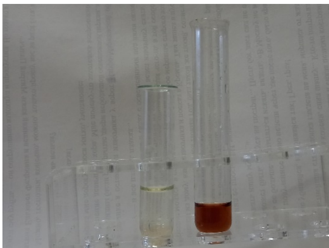
Рис. 4 Жидкости для вейпа без никотина (слева) и с никотином (справа) после добавления пероксида водорода и концентрированной серной кислоты
